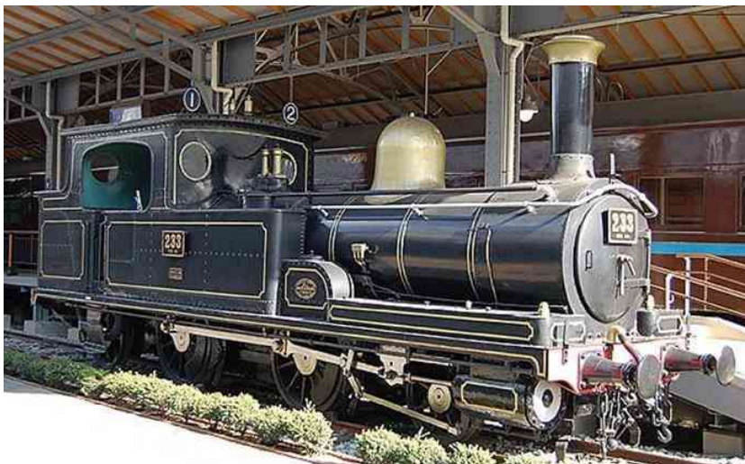
1903年，大阪汽车制造株式会社，制成230型233号蒸汽机车（仿制英国A8型），现存于大阪交通科学博物馆。这是日本早期仿制的蒸汽机车之一，主要零部件自英国进口，车轮配置为2-4-2，曾在我国台湾省的铁路上使用。
