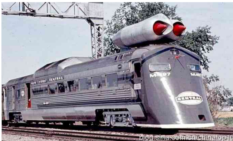
1966年，美国纽约中央铁路公司与通用电气合作，在Budd公司制造的铁路柴油客车基础上，研制出世界上第一台喷气式火车头。它被命名为M-497，最高时速达到每小时296公里。
