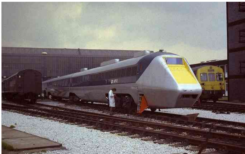
1972年夏天，英国研制的APT-E高速试验列车，四节编组，采用燃气轮机作为动力。
